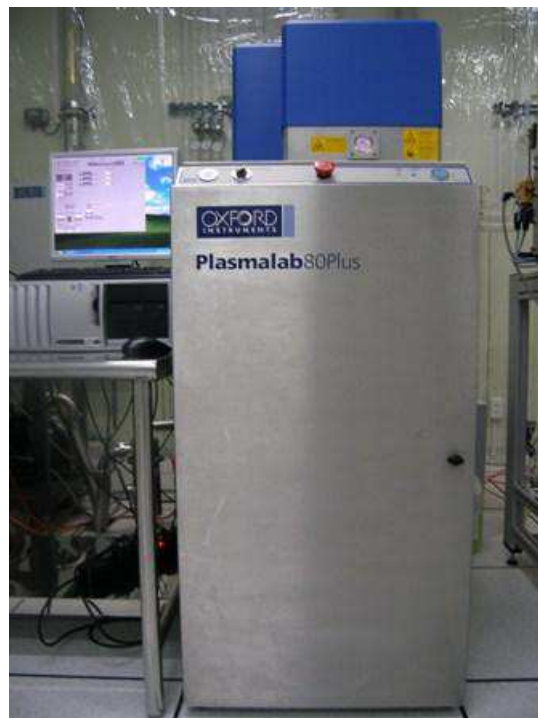
Figure 3.2 – Equipement de gravure par ions réactifs Plasmalab80 +
