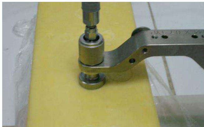
Figure 5.18 - La caractérisation de la permittivité du fromage
